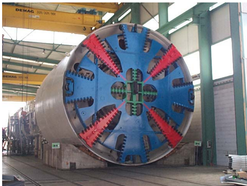
Obr.1 TBM použité pro ražbu tunelu ART
